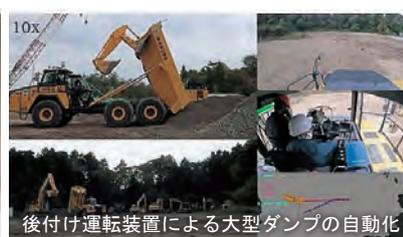
後付け運転装置による大型ダンプの自動化
