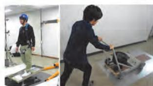
床材料の耐滑性評価システムの開発
