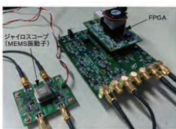
高性能ジャイロシステムと、制御用の機能ブロック図
