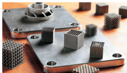
3D プリンターにより造形したラティス構造体
