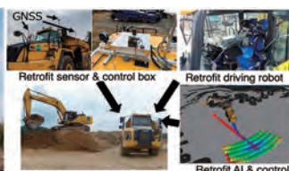
運転ロボットでダンプを自動化
