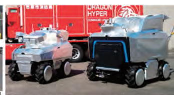
自律消防ロボットシステム
