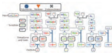
酵素を使ったDNA分子計算回路（USG）の設計図
