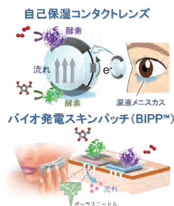
図② バイオ電池で駆動するマイクロ創流デバイス
