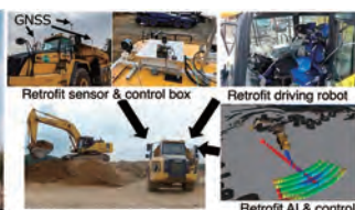
運転ロボットでダンプを自動化
