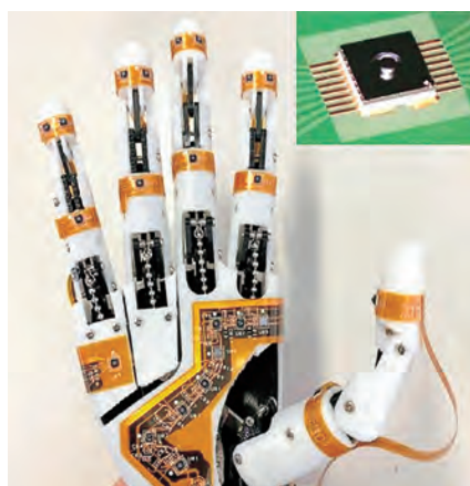
図1 ロボットハンド*に実装した集積化触覚センサ *東京都立産業技術高等専門学校 深谷直樹准教授提供
